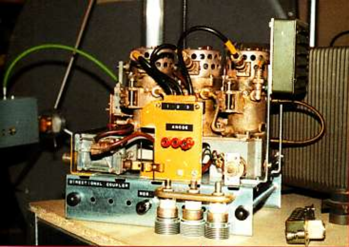
23 cm. eindtrap met zichtbaar een directional coupler
